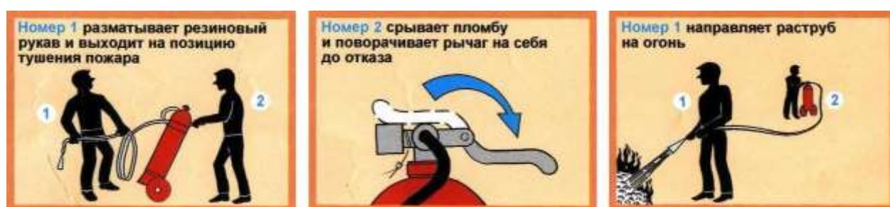
Рис. 6.5. Приведение в действие передвижного углекислотного огнетушителя
