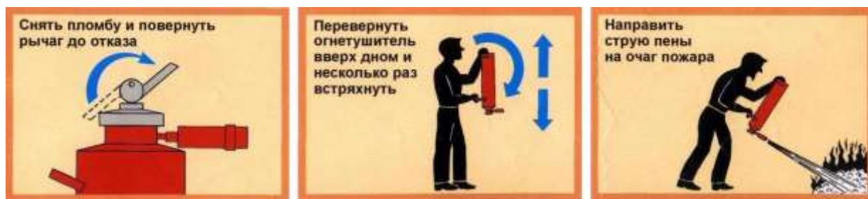
Рис. 6.9. Приведение в действие химического пенного огнетушителя
