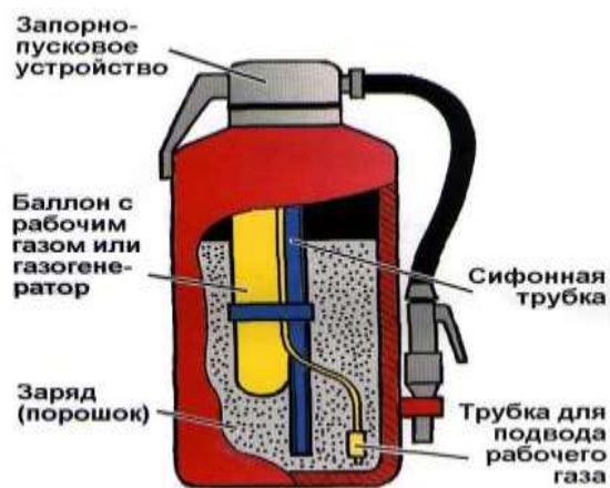
Рис. 6.13. Внутреннее строение порошкового огнетушителя со встроенными газовыми
