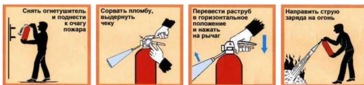
Рис.6.4. Приведение в действие ручного углекислотного огнетушителя
