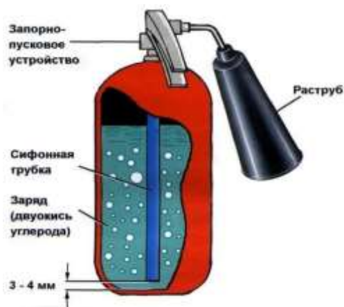
Рис. 6.1. Внутреннее строение углекислотных огнетушителей
