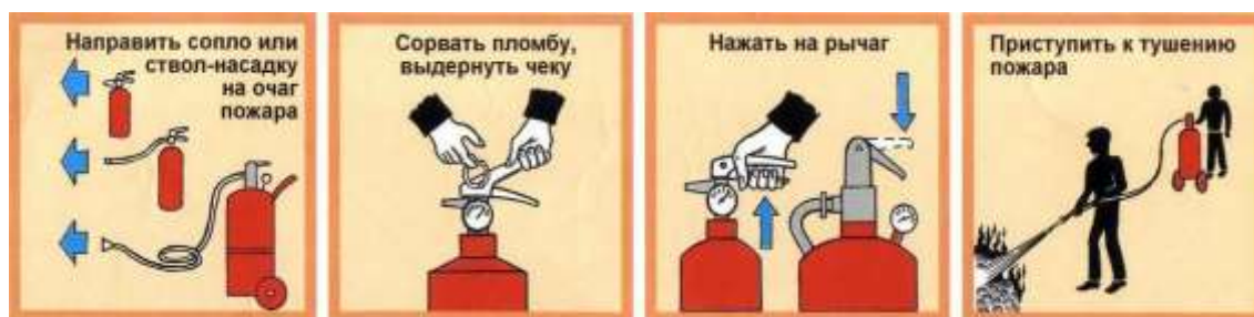
Рис. 6.17. Приведение в действие закачного огнетушителя
