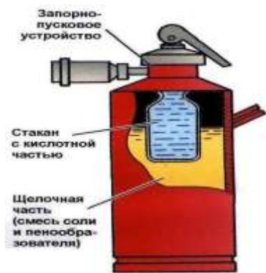
Рис. 6.8. Внутреннее строение химических пенных огнетушителей
