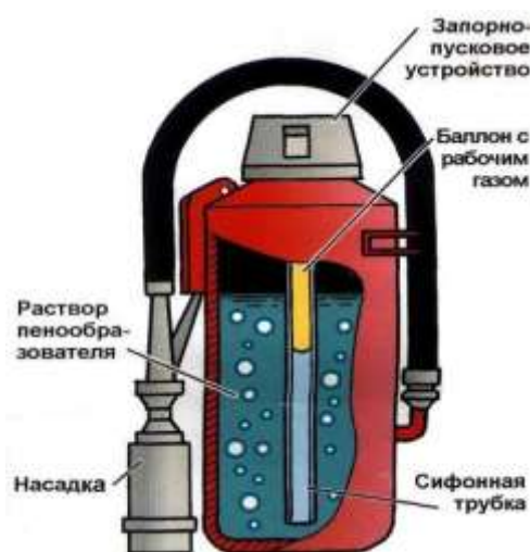
Рис. 6.10. Внутреннее строение воздушно-пенных огнетушителей
